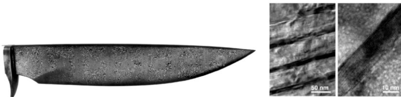
Рис. 4. На рисунке справа показана структура клинка из дамасской стали (см. слева), где видны нанопроволочки длиной в несколько сотен нанометров 22
